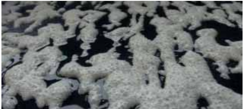
Marquage structuré (pour que le marquage soit visible au dessus du film d'eau) saupoudré de microbilles de verre. Légende: © Sovitec
